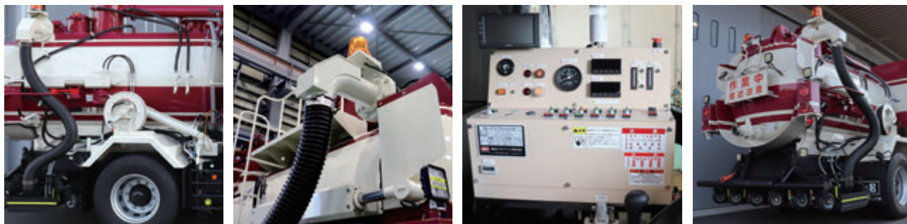
洗浄リール 摩耗対策(連結配管) 操作盤(キャビン内) 洗浄アタッチメント
