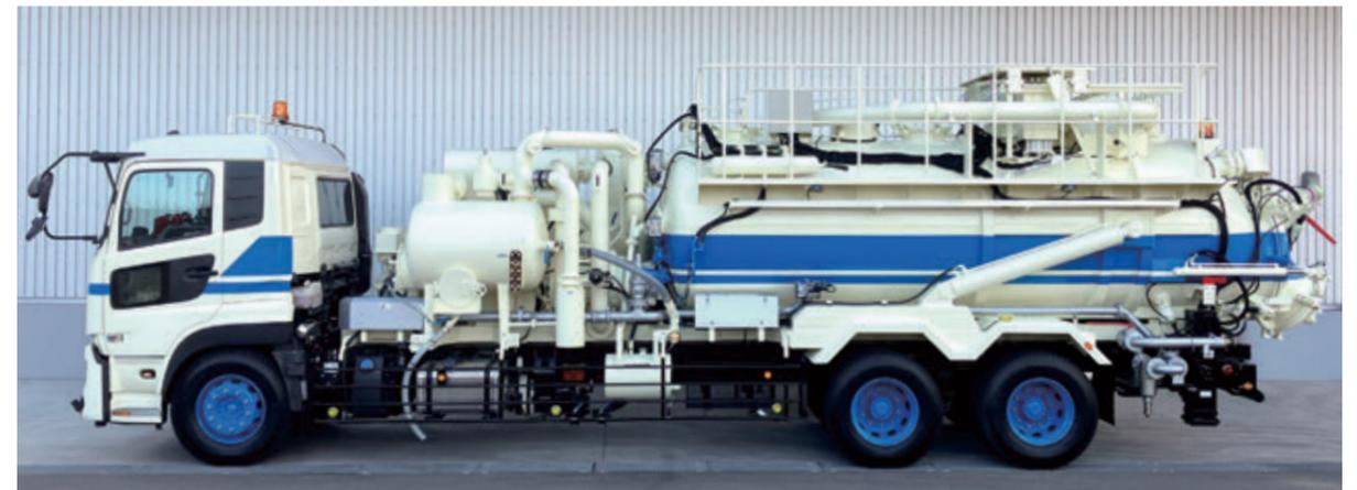
製鉄所構内で発生するダスト等の回収・運搬・排出作業にご使用いただいている粉粒体吸引圧送車です。吸引口の他に、レシーバータンクの上部にはシリンダーで昇降する投入口を設け、構内設備からダストを直接投入可能です。また、圧送ホースの抜き忘れを防止する警報装置など、各種の安全装置を備えています。
